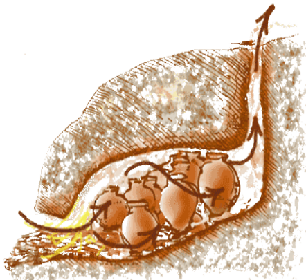
איור 3- שריפה בתנור גדה
